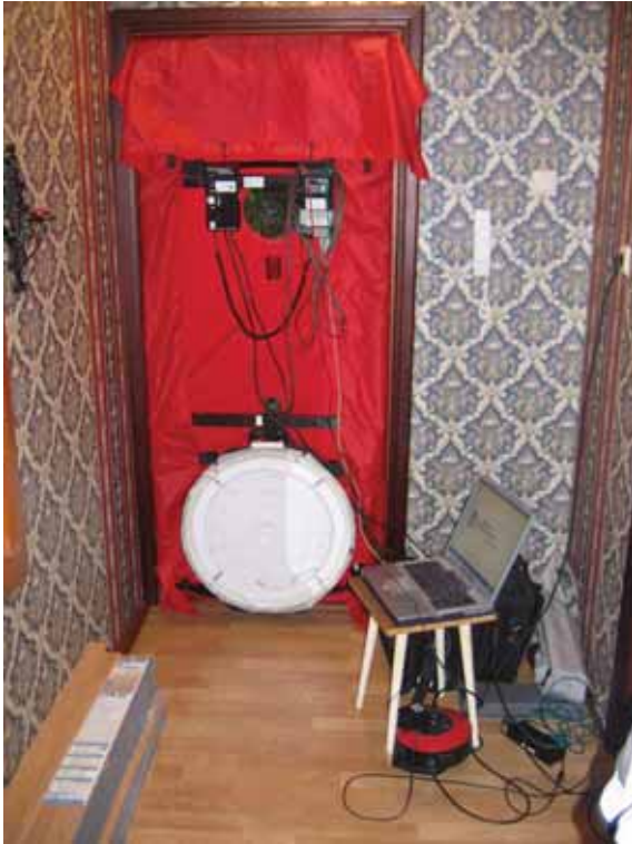
Joonis 8.2 Õhupidavuse mõõteseade vaadatuna korterist (vasakul) ja trepikojast (paremal)
