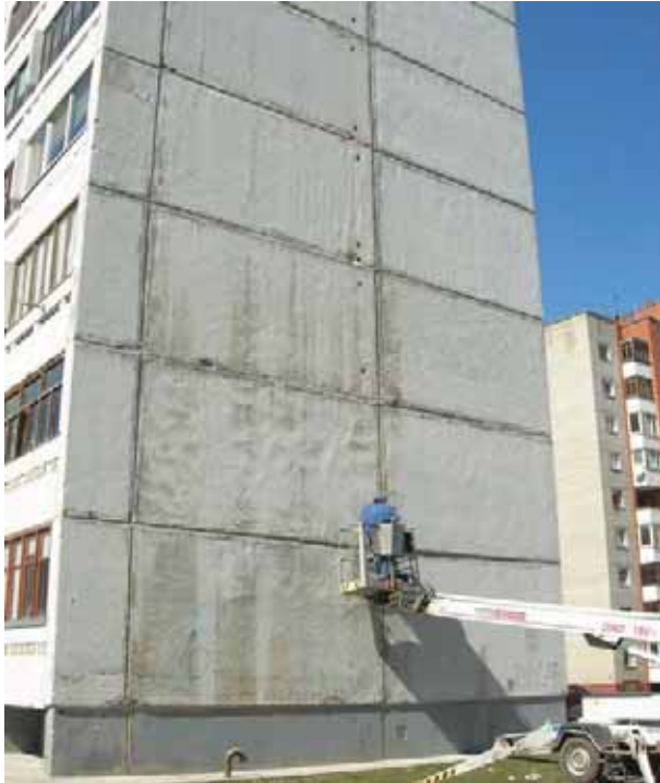
Joonis 3.9 Välisseinapaneelidest proovikehade võtmine hoone erinevatelt kõrgustelt
