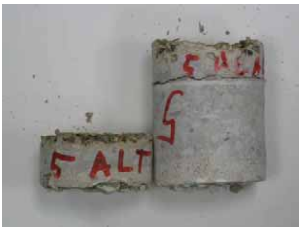
Joonis 3.11 Samast välisseinapaneelist puuritud kaks proovikeha: soojustust on ühes paneeli servas 10 cm vähem (vasakul). Väliskooriku paksus võib olla isegi vaid 2-3 cm.
