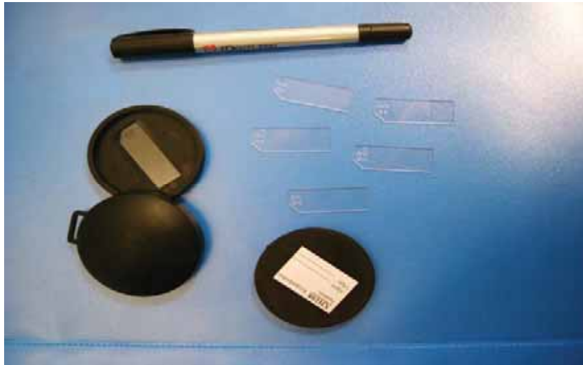
Joonis 17.2 Alfatundlikust plastikust (CR-39) detektorid (Pahapill jt. 2003)
