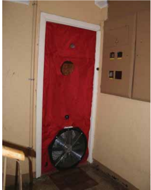
Joonis 8.2 Õhupidavuse mõõteseade vaadatuna korterist (vasakul) ja trepikojast (paremal)
